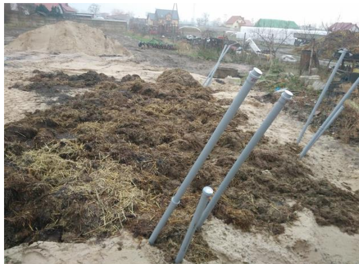
Рис. 2. Встановлені п'єзометри та формування для кондиціонування гною формування штабелів у господарстві № 1 (G1)
